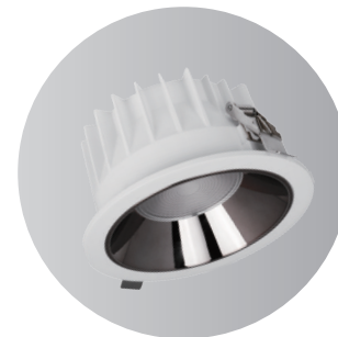
KT6765 36W / 2322LM / 50° size Ø195x95mm cutout Ø180mm
