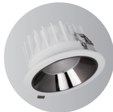
KT6761 22W / 1452LM / 50° size Ø139x78mm cutout Ø125mm
