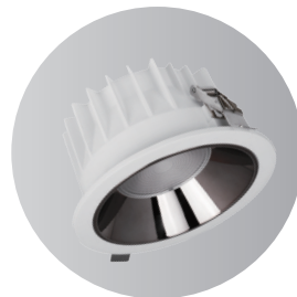
KT6763 28W / 1518LM / 50° size Ø160x85mm cutout Ø145mm
